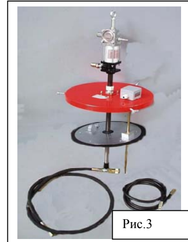
Рис.3 Общий вид бочечного насоса и размещение его в машинном отделении ЭШ 15.90
