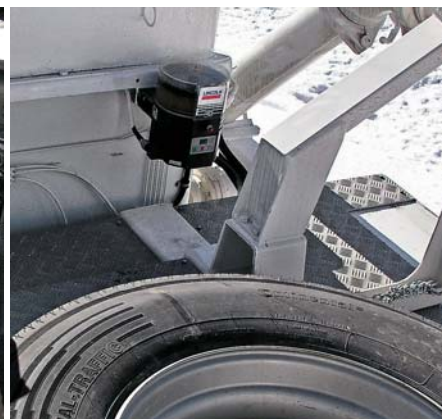
ЦСС на автобетононасосе CIFA K40 XRZ
