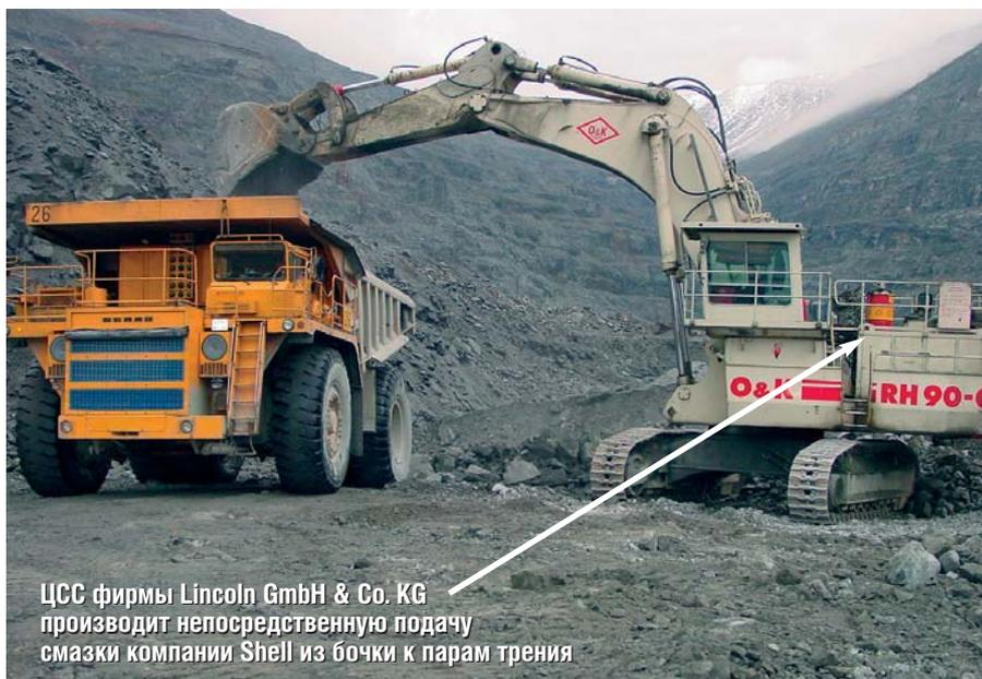
ЦСС фирмы Lincoln GmbH & Co. KG производит непосредственную подачу смазки компании Shell из бочки к парам трения
