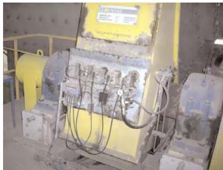
ЦСС фирмы Lincoln с применением смазки Molleus 205 фирмы Shell
