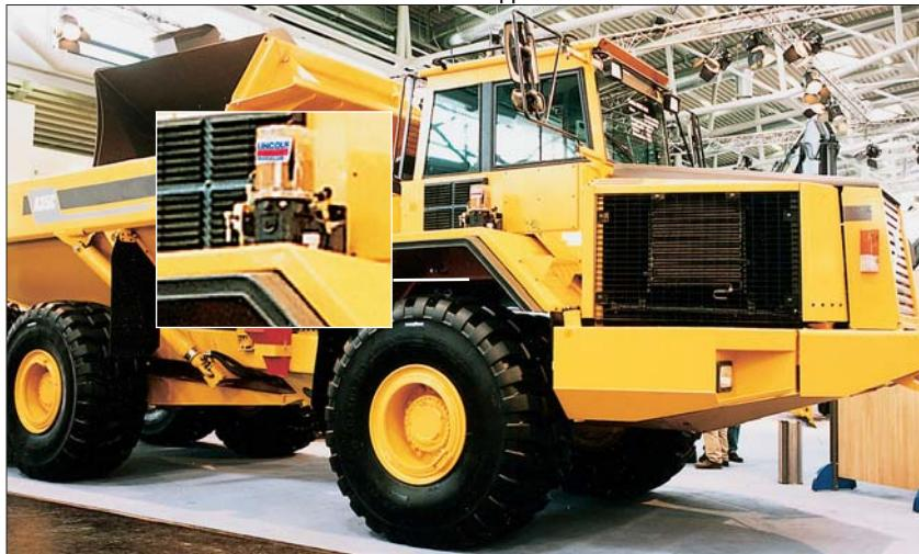
смазывание подшипников с высоким противодавлением. До трех независимых смазочных контуров могут обеспечить смазочным веществом большое число точек трения. Система легко контролируется и гарантирует поступление необходимого количества смазочного вещества.
