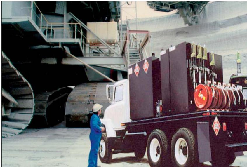
Lubrovan Сервисный смазочный агрегат с гидравлическим насосом Power-Master-III
