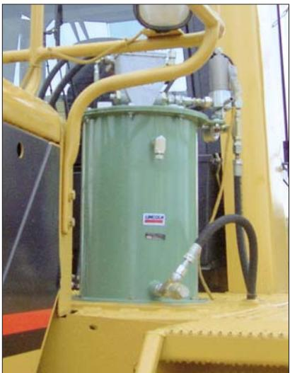
FlowMaster насос централизованной системы смазки
