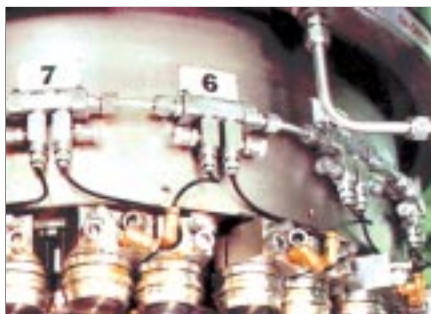
Механизм с однолинейными питателями
