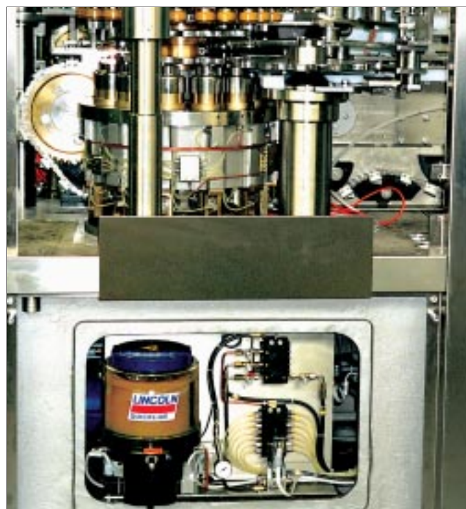
Разливочная машина с прогрессивной системой типа «Quicklub»
