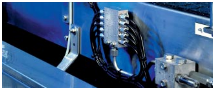
Ленточный транспортер с двухлинейным и прогрессивным питателями
