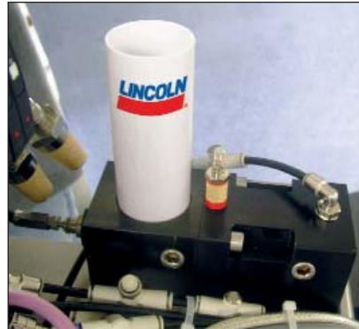
Клапан сброса воздуха можно установить таким образом, что насос выполняет в течении одной минуты только один смазочный цикл (ход смазочного пресса) и поставляет 0,14 см<sup>3</sup> смазочного материала – или по заводской настройке 2,8 см<sup>3</sup>. При объеме подачи смазки от 0,14 см<sup>3</sup> 150г картушки хватает на 3-4 дня, затем картушу меняют.
